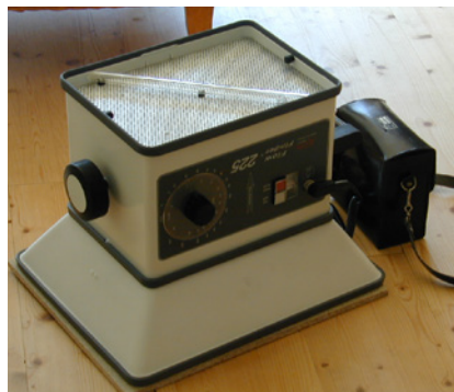
Ein Messgerät zur Bestimmung der Volumenströme an Zu- und Abluftventilen
